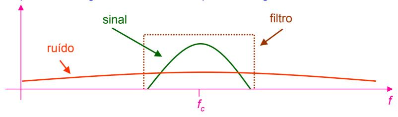
Sinal na saída do filtro de faixa estreita: função amostra de um processo aleatório de faixa estreita.
