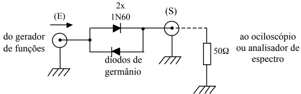
Figura 3: Circuito com distorção *cross-over*.
